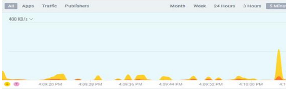
Hình 3. Kiểm tra lưu lượng Card mạng tấn công UDP trên Palo Alto Firewall
